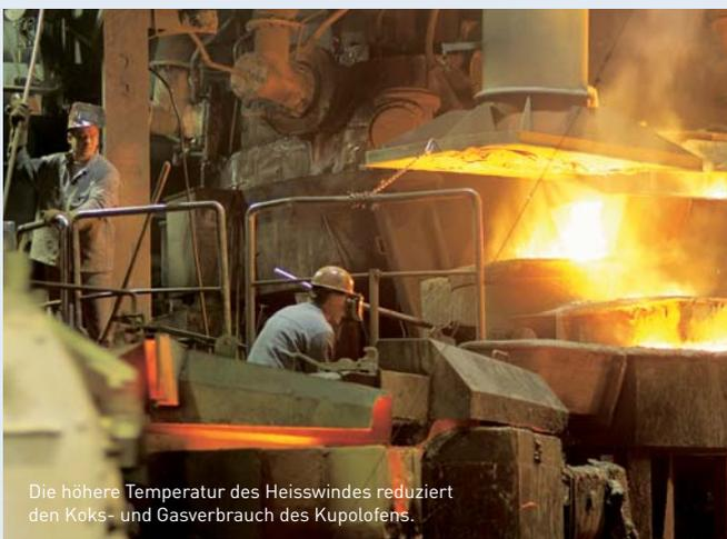
Die höhere Temperatur des Heißwindes reduziert den Koks- und Gasverbrauch des Kupolofens.
