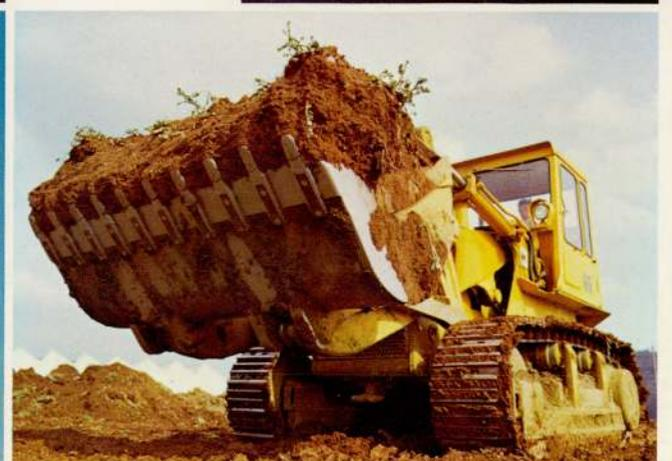
Baggerzähne aus hochverschleissfesten Gusslegierungen für harten Einsatz an Baumaschinen
