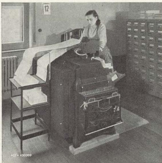
Bild 6 - Tabelliermaschine im Betrieb bei Verwendung
