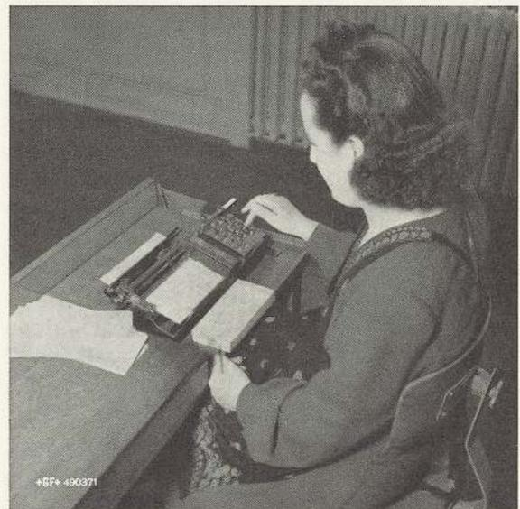
Bild 2 - Mechanischer 10-Tasten-Locher
