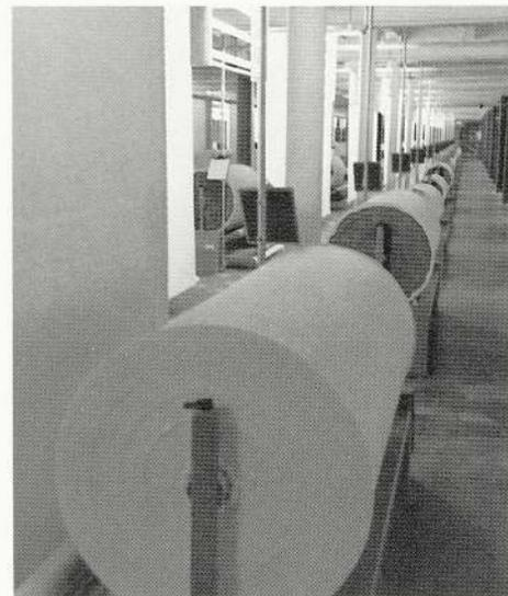
Blick in das Untergeschoss; das Gewebe wird zu grossen Rollen aufgewickelt.
