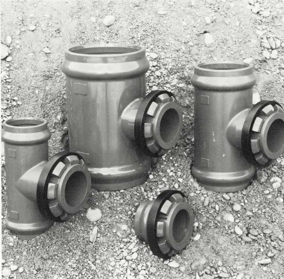
*Der montagefreundliche, drehbare Spreizringflansch aus PVC ermöglicht problemlos das Anflanschen des neuen STEMU-Fittingsystems mit Metallschiebern und Hydranten bei Versorgungssystemen.*
