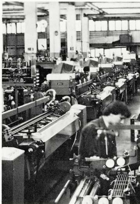
Montageband für die neue Greiferwebmaschine F 2001.
