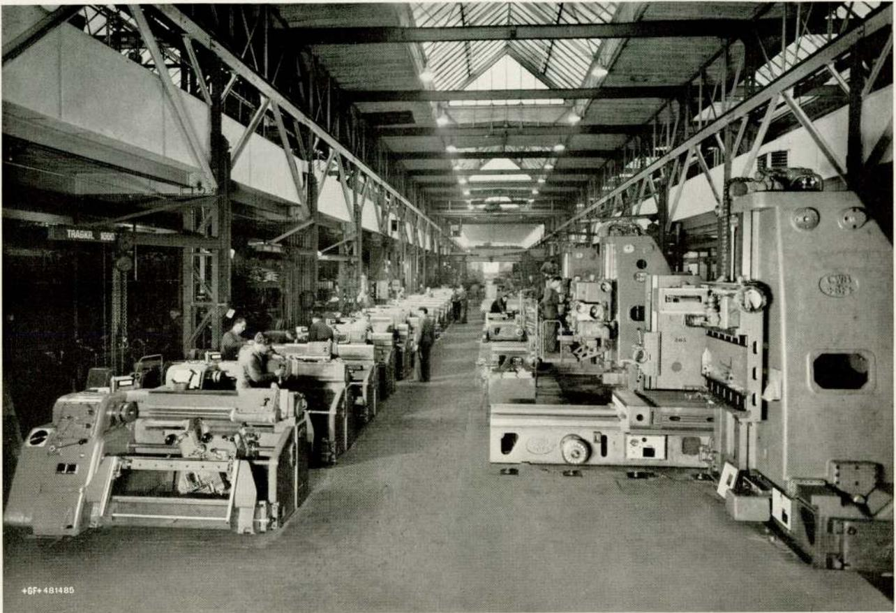
Serienmontage von +6F+ Kopier-Drehmaschinen und von CWB / +6F+ Fräs- und Bohrwerken
