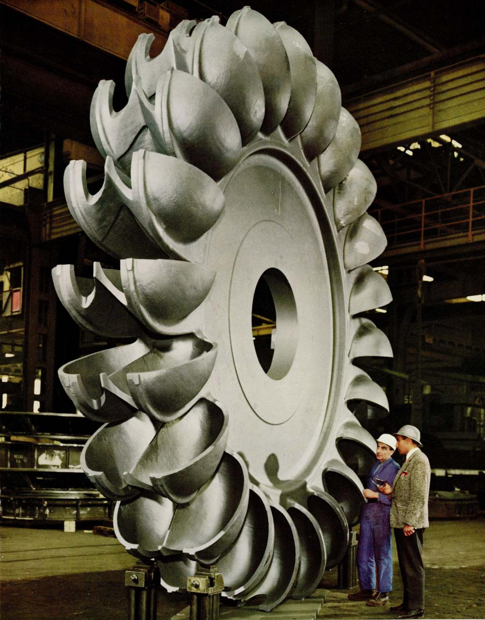
Peltonrad für das Kraftwerk NEW COLGATE/Kalifornien USA
