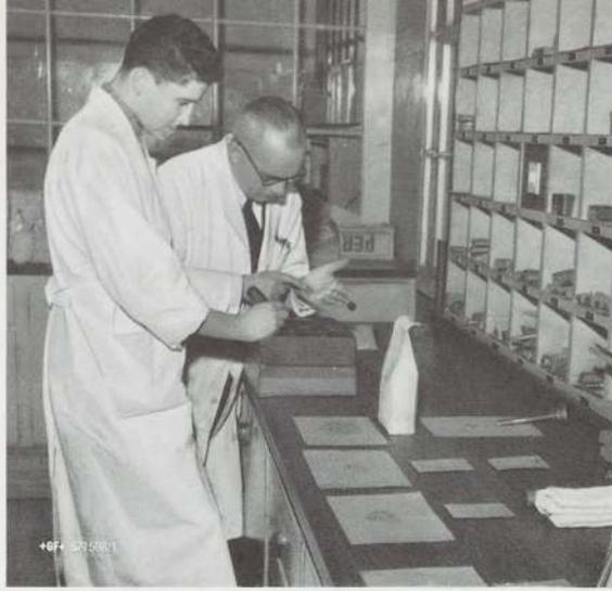
*Die Vorbereitung der verschiedenen Proben zur Analyse vermittelt dem Lehrling umfassende Materialkenntnisse. Hier prüft der Lehrmeister die Feinheit einer Mahlprobe.*
