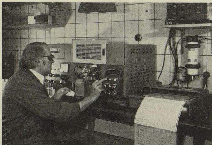
Physik-/Chemie-Labor: Atom-Absorptions-Spektralphotometer, zu deutsch: eine Einrichtung zum Messen von kleinen und kleinsten Konzentrationen von Elementen in flüssigen Proben, beispielsweise Abwässern.
