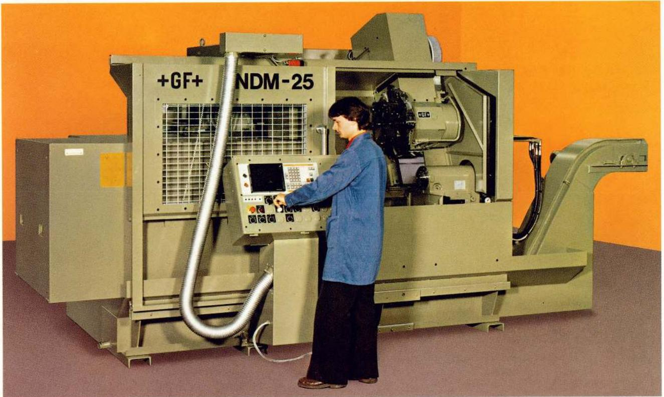
Heute: Eine moderne, numerisch gesteuerte +GF+ Drehmaschine, die NDM-25.
