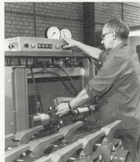
Blick in das Kunststoffarmaturenwerk der Georg Fischer Plastik AG in Seewis/GR. Im Bild überprüft ein +GF+ Mitarbeiter fertig zusammengesetzte +GF+ Absperrklappen aus PVC auf ihre Dichtigkeit und Funktionstüchtigkeit – damit jedes Produkt den hohen Qualitätsanforderungen entspricht.
