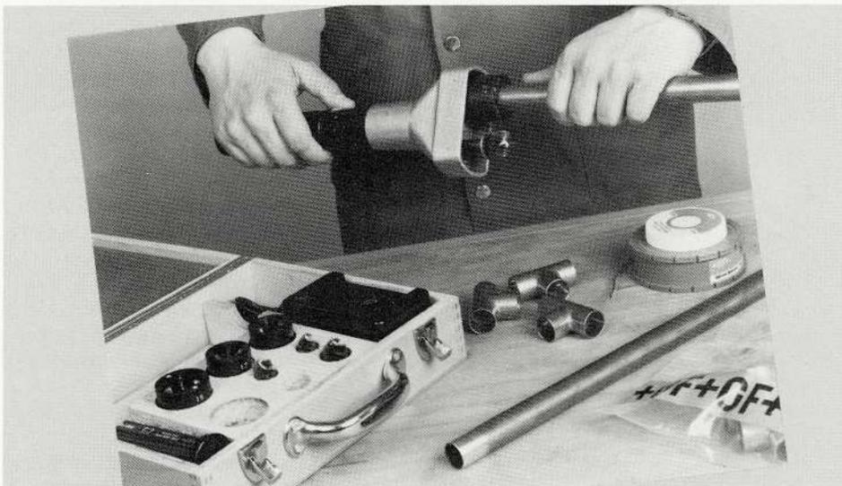
Mit dem neuen +GF+ Orbit lassen sich Kupferrohre und Fittings mühelos und sekundenschnell reinigen. Eine Akku-Ladung reicht für mehrere 100 Reinigungen. Reinigungsköpfe für die gebräuchlichsten Rohrdurchmesser 10–22 mm, Reserve-Akku mit Ladegerät sind im handlichen Orbitkoffer griffbereit vorhanden.
