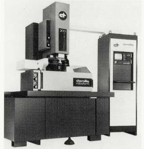
Senkerodiermaschine Roboform 200
